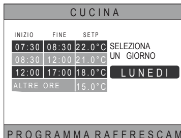
fig. 43 Esempio con 3 fasce orarie
